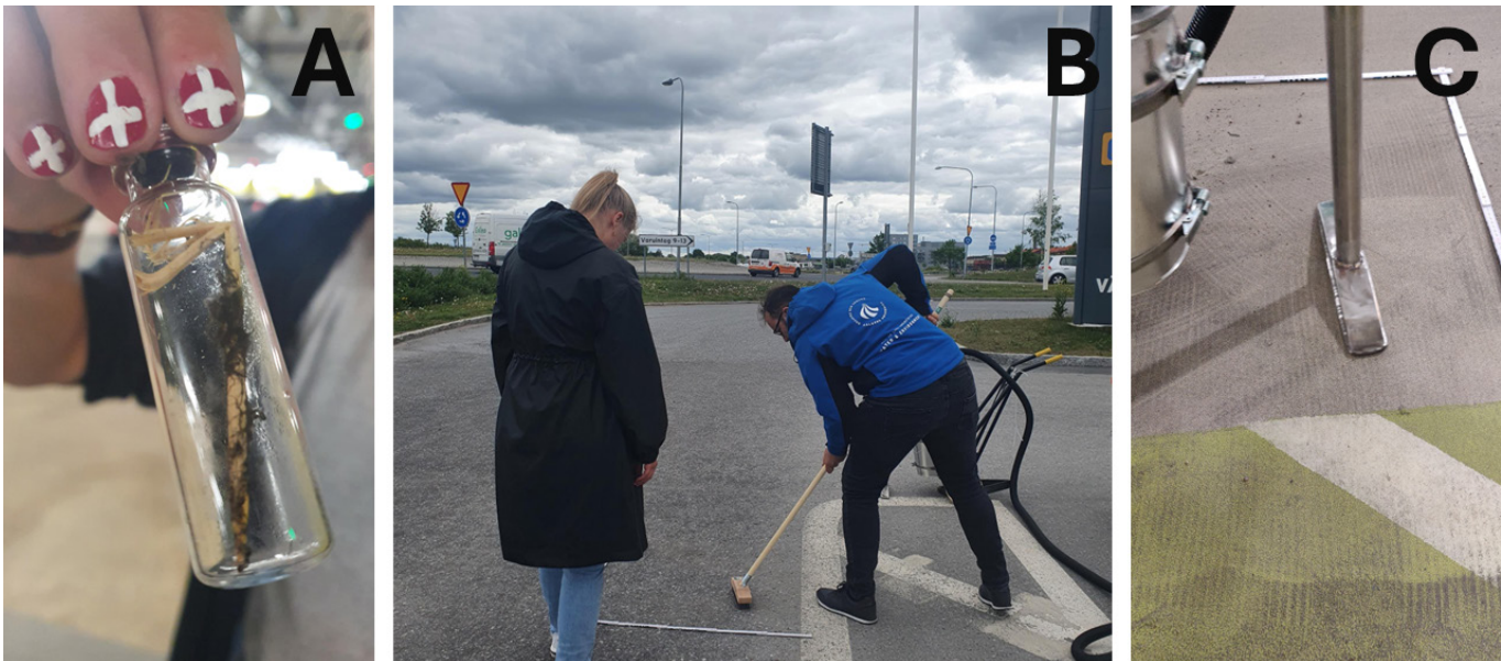
Figur 2 I studiet blev der også indsamlet spindelvæv, idet de er passive prøvetagere for mikroplast. Figur A viser et eksempel på en sådan prøve. Figur B viser løsning af partikler i vejen før brug af Dusty. Figur C viser opsamling af prøver med Dusty.
