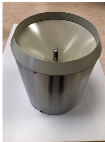
Rimco med malet tragt, varmelegeme samt temperatursensor monteret
