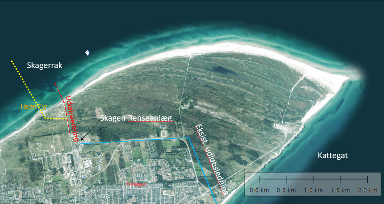
Figur 1 Eksisterende udløbsledning og første forslag til nyt trace mod Skagerrak, rød linje. Valgt tracé, gul linje.
