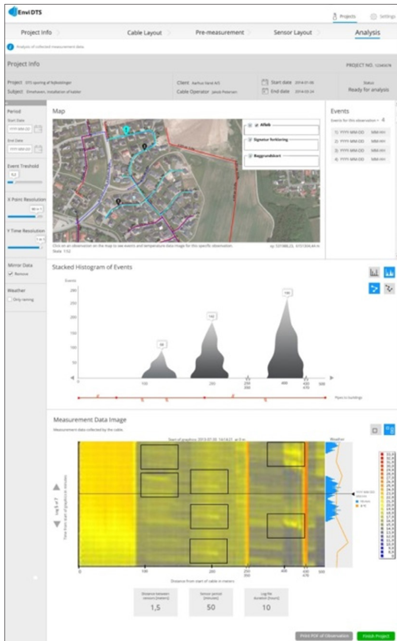
Figur 6 Screendump fra portalværktøjet under udvikling (figurerne er dummies, der viser princippet i metoden). Øverst fremgår workflowet i værktøjet, der strækker sig fra planlægning af udlægningen af kablet til den egentlige repræsentation af resultaterne. Det øverste kort viser kablets udlægning, kortet i midten viser et bud på en måde at repræsentere en statistisk analyse af sammenfaldet imellem regnhændelser og detekterede inflow events, og nederst ses rådataene fra målingen sammenholdt med nedbørsdata. Til venstre fremgår de muligheder, brugeren har til analyse af dataene.
