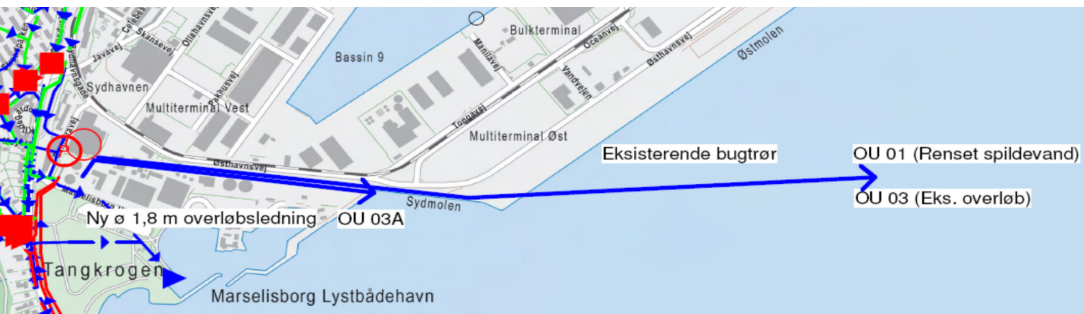
Figur 1 Placering af eksisterende bugtrør (OU01/OU03) og ansøgt nyt overløb (OU03A).
