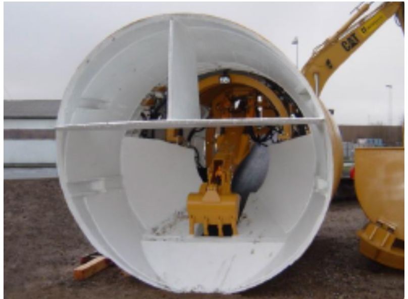
Figur 3 Tunneleringsmaskine med åben front.
