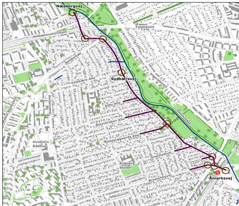
Oversigtskort med ledningsanlæg og adgangsskakte.
