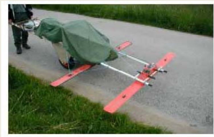
Århus Amt – opfølgende undersøgelse m. Georadar - grundvandsspejlets hældning
